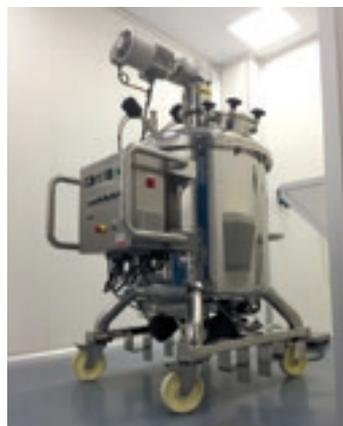
Réacteur mobile avec agitation lente conçu pour travailler sous vide et sous pression, avec tableau électrique assemblé à la machine. Finition extérieure poli miroir.
