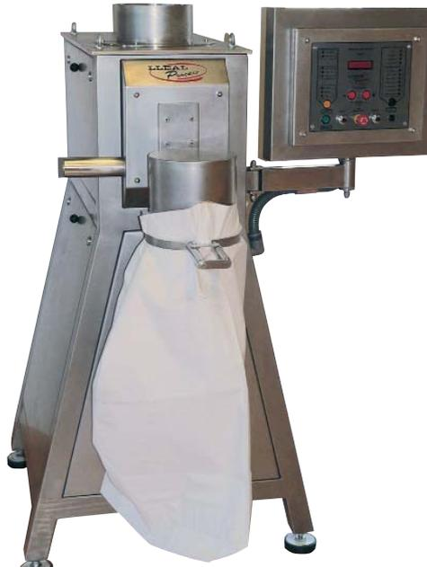
Ensacadora S-50 con cabezal para sacos abiertos
